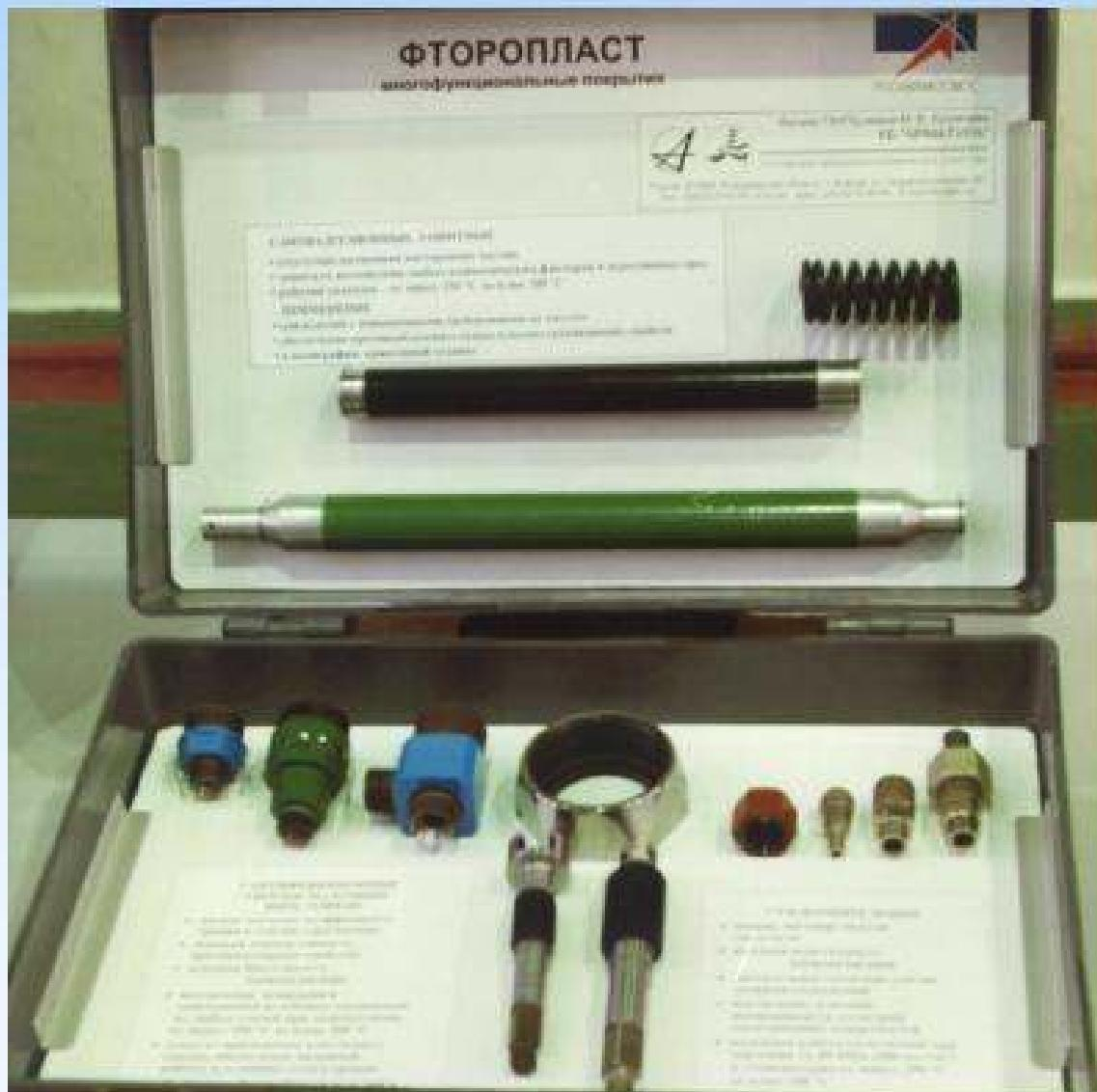
Нанесения фторопластовых покрытий на наружные и внутренние поверхности изделий из конструкционных материалов позволяет улучшить твердосмазочные, биостойкие, антифрикционные, износостойкие, электроизоляционные, уплотнительные, антиадгезионные и антистатические свойства изделий.
